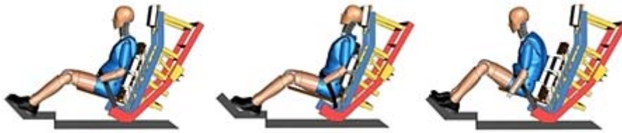
Figura 02. El ABAQUS BioRID II es un "dummy" empleado para evaluar el peligro de lesiones en las cervicales durante una colisión en la zona trasera del vehículo. Aquí se simula un lapso de tiempo de 250 milisegundos. Cortesía de SIMULIA Dassault Systèmes
